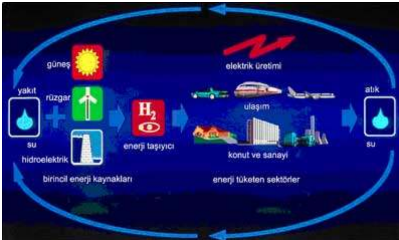
Figür 1. Temiz Hidrojen Enerji Sistemi
